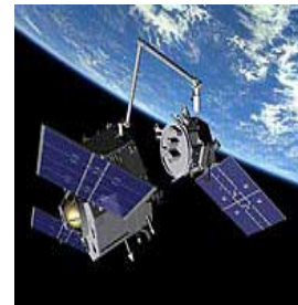
Entretien d'engins spatiaux en orbite : illustration de l'engin spatial Orbital express. (Image : Boeing)
